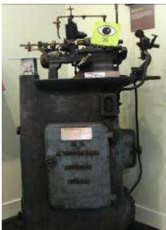
**N°25 Torno:** Máquina para torneear los piñones y diferentes piezas cilíndricas y el otro para tallar los dientes de los piñones.
